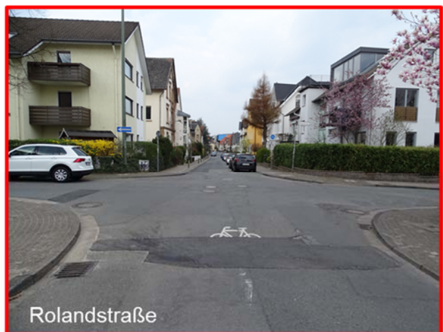
Abb. 31: Mangelhafte Oberfläche und Hindernisse im Lichtraumprofil
