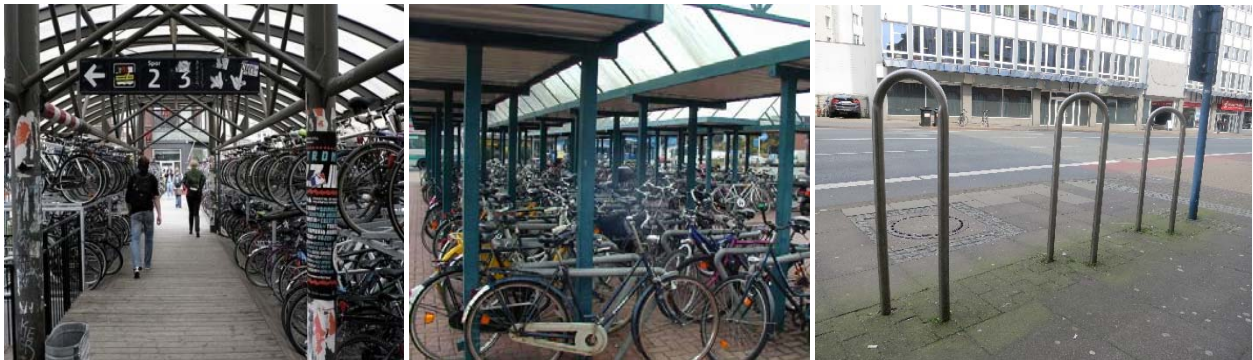
Abb. 54: links und Mitte: Fahrradabstellanlage mit hoher Kapazität (Typ 3); rechtes Foto: Fahrradabstellanlage mit niedriger Kapazität (Typ 4).
