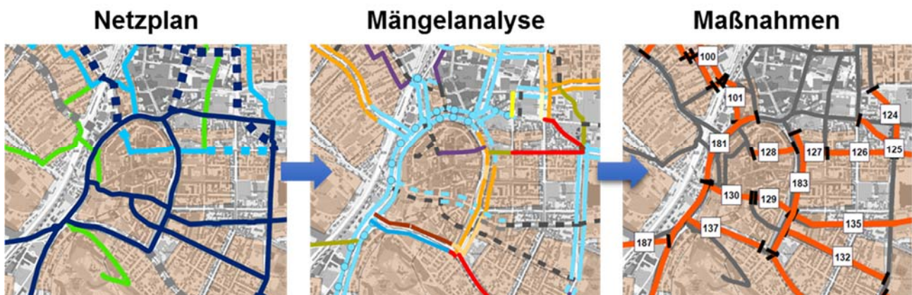
Abb. 32: Umsetzung der Mängel und Netzlücken in ein Maßnahmenkonzept
