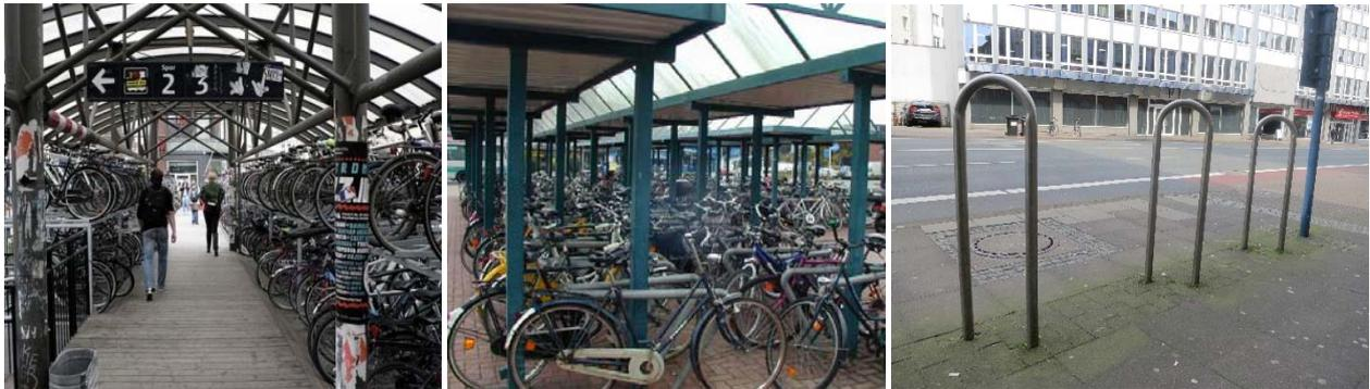
Abb. 54: links und Mitte: Fahrradabstellanlage mit hoher Kapazität (Typ 3);
