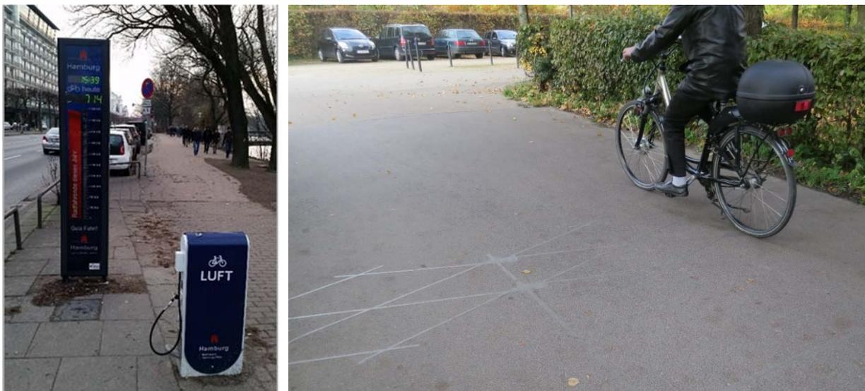
Abb. 65: Dauerzählstellen in Hamburg (links) und Brühl (rechts)
