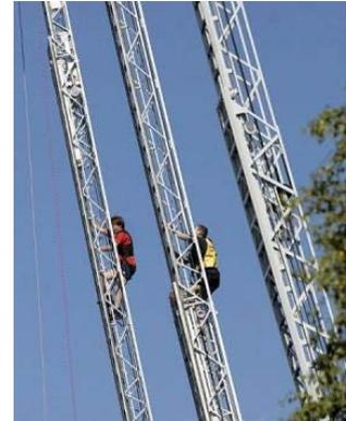
An der Drehleiter wird mit einer Bandschlinge und einem Karabiner an der Abstützung oder ggf. einem Schäkkel an der Drehleiter eine HMS-Sicherung vom Sicherungspersonal angebracht.
